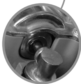
Position du moteur verrouillé : Le téton doit être en position ressortie
